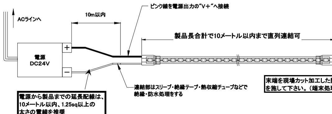
電源から製品までの延長配線は、10メートル以内、1.25sq以上の太さの電線を推奨
