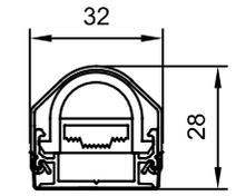
設置の際必要なスペースとして幅32mmに対し、左右共に各10mmずつ空けてください。
