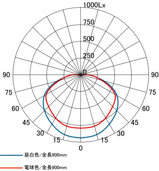
■ 水平面照度分布 器具取付高さ=0.3m 単位 : Lx
