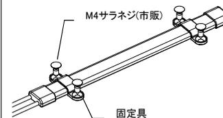
本体を配置し、固定具を噛ませてM4サラネジで固定する(推奨:180mmピッチ)
