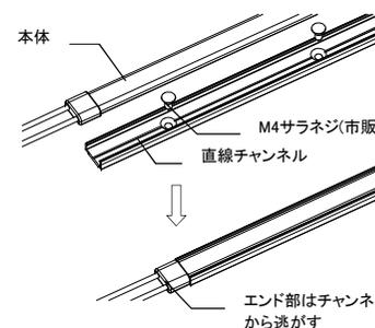
モールカッターなどで直線チャンネルを必要な長さにかuttingしてM4サラネジで固定し、チャンネルの溝へ本体をゆっくりと押し込む
