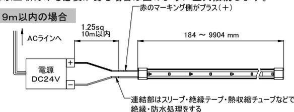
連結部はスリーブ・絶縁テープ・熱収縮チューブなどで絶縁・防水処理をする
